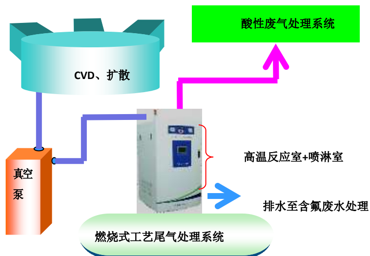
图 8-16 燃烧水洗工艺尾气处理流程示意图
